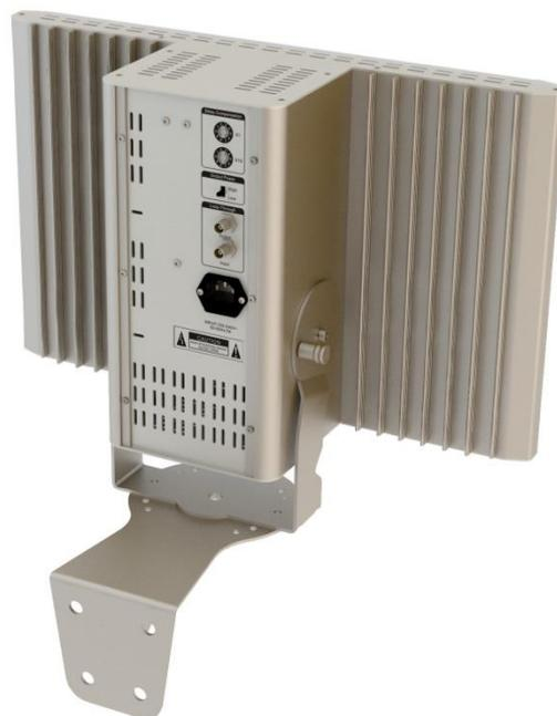
Инфракрасная излучающая панель принимает несущий сигнал, генерируемый передающим устройством ICS-IR-RX8 и передает инфракрасное излучение до 32 каналов распределения аудиосигнала. Возможно каскадное соединение по пяти ИК-панелей последовательно. Когда несущий сигнал не принимается, инфракрасная излучающая панель переходит в режим ожидания.
