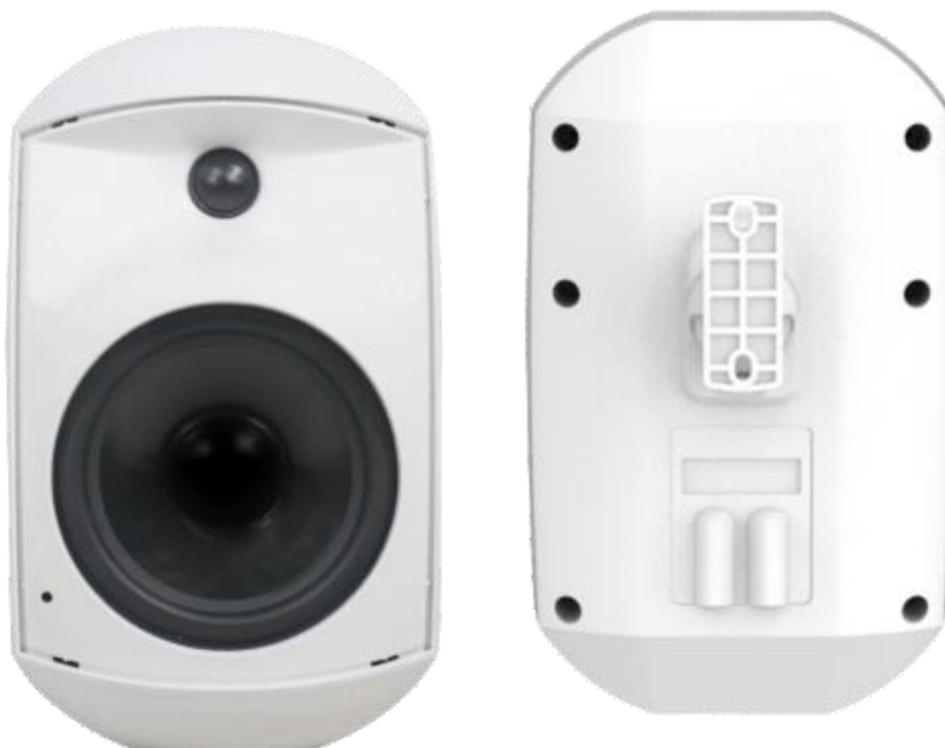
Двухполосный влагозащищенный настенный громкоговоритель состоит из низкочастотного и высокочастотного динамиков. НЧ-динамик 4" изготовлен из водостойкой бумаги с резиновым подвесом, ВЧ-динамик 1" имеет направленное шелковое купольное исполнение с ферромагнитным охлаждением.
